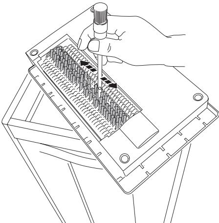
**RU** Периодически очищайте режущий механизм аппарата.
