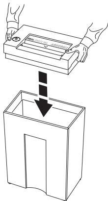
**RU** Установите механизм на корпус аппарата.
