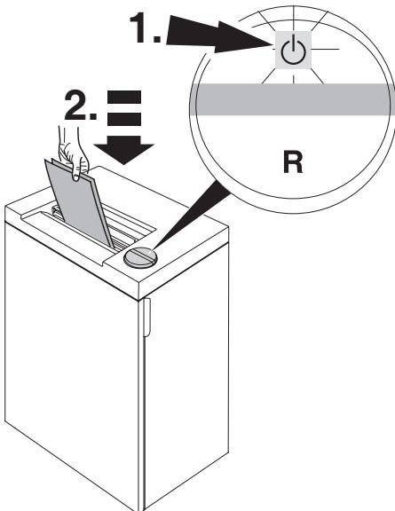
**ES** Presionar botón (1.) a luz verde indica que está listo para funcionar. Inicio automático con el indicador en verde en caso de inserción de papel (2.). Modo de espera automático que se apaga tras 15 minutos. La máquina puede apagarse en cualquier momento pulsando la tecla . El indicador LED verde se apaga . Con ello, no hay habrá ningún consumo.
