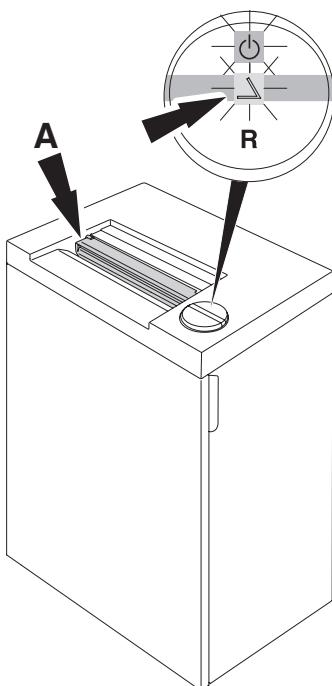
**IT** Blocco automatico se la linguetta di sicurezza è sollevata. (I simboli  $\downarrow$  e  $\odot$  lampeggiano alternatamente). Chiudere la linguetta di sicurezza e premere l'interruttore principale  $\odot$ , la carta viene distrutta. Per eliminare eventuali frammenti dovuti al blocco, la macchina si avvia, con movimento in reverse, per un breve periodo con linguetta di sicurezza sollevata. Se necessario ripete l'operazione più volte.
