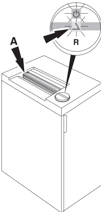
**DE** Autom. Stopp wenn Sicherheitsklappe (**A**) geöffnet wird (Symbole und blinken abwechselnd).
