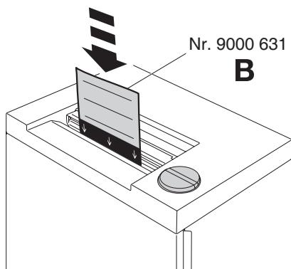
**DE** Bei jedem gefüllten Auffangbehälter oder bei nachlassender Schneidleistung Schneidwerk ölen,
