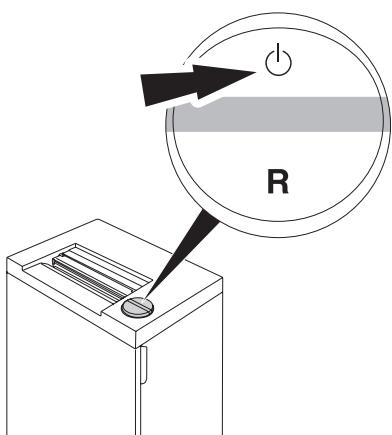
**DE** Autom. Standby - Abschaltung nach 15 Minuten. Maschine kann jederzeit durch Drücken des Schalters ausgeschaltet werden. Grüne Kontrollleuchte erlischt. Danach verbraucht die Maschine keinen Strom mehr. Innerhalb dieser 15 Minuten verbraucht der Aktenvernichter folgende Wh Energie.
