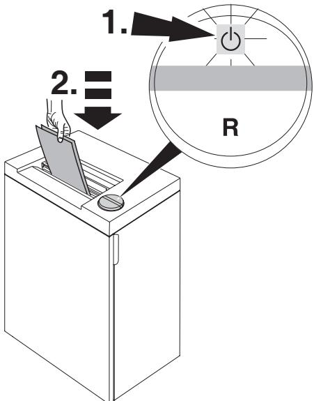
**DE** Schalter drücken (1.) : grünes Licht leuchtet, Maschine betriebsbereit. Autom. Anlauf bei Papierzufuhr (2.). Autom. Standby - Abschaltung nach 15 Minuten. Maschine kann jederzeit durch Drücken des Schalters ausgeschaltet werden. Grüne Kontrollleuchte erlischt. Danach verbraucht die Maschine keinen Strom mehr.
